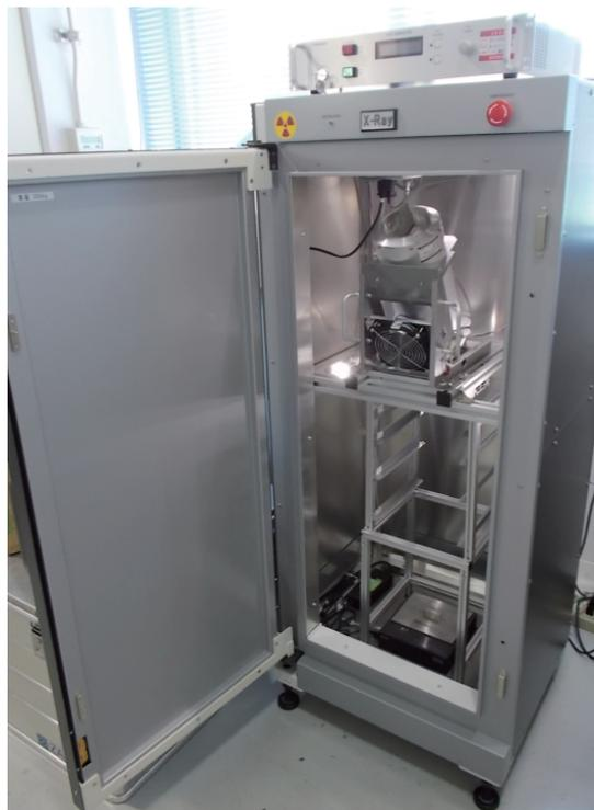
図 2.14 X 線発生装置(松定プレシジョン製 XF 18-90-01)
