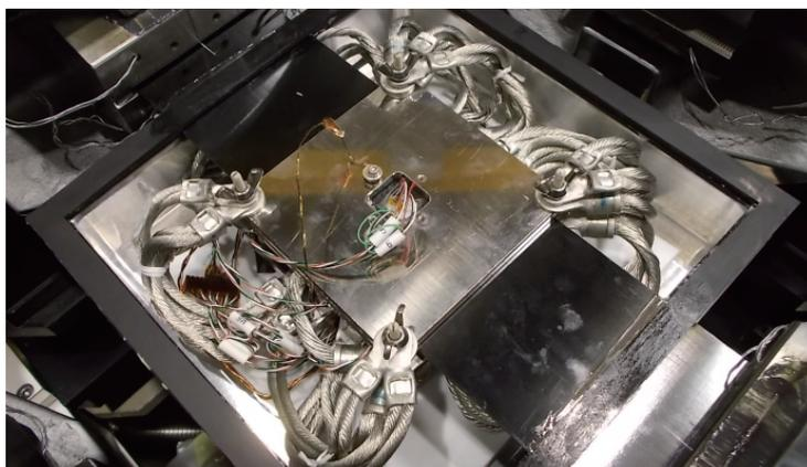
図 2.11 極低温環境槽内でのひずみ測定(有孔冷却プレート使用)
