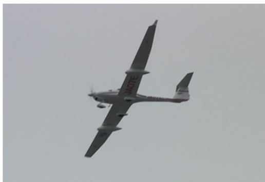
図 5-2 上昇気流中で電力回生する試験機
