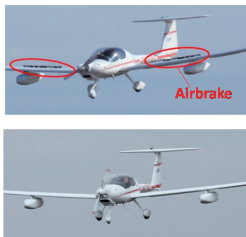
図 5-3 通常のエアブレーキによる降下（上）と回生エアブレーキシステムによる降下（下）
