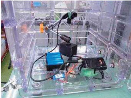
図 13 デシケータ内の搭載カメラ
