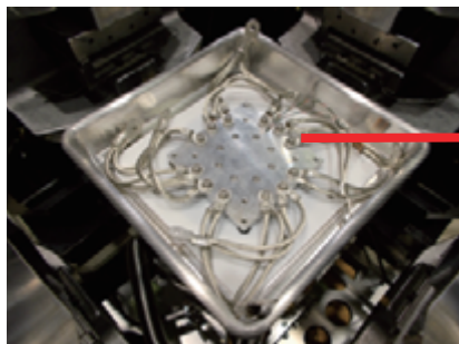
図 5.17 コールドヘッドに取り付けられたコールドヘッドプレート
