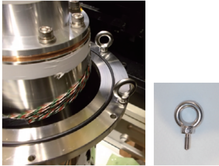
図 5.1 環境槽下部へのアイボルトの取り付け
