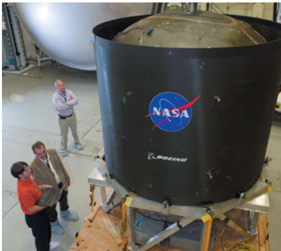
(a) 直径 2.4m タンク
