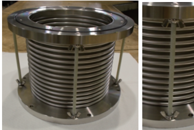
図 5.24 ベローズ部品の GFRP ねじと蝶ねじ
