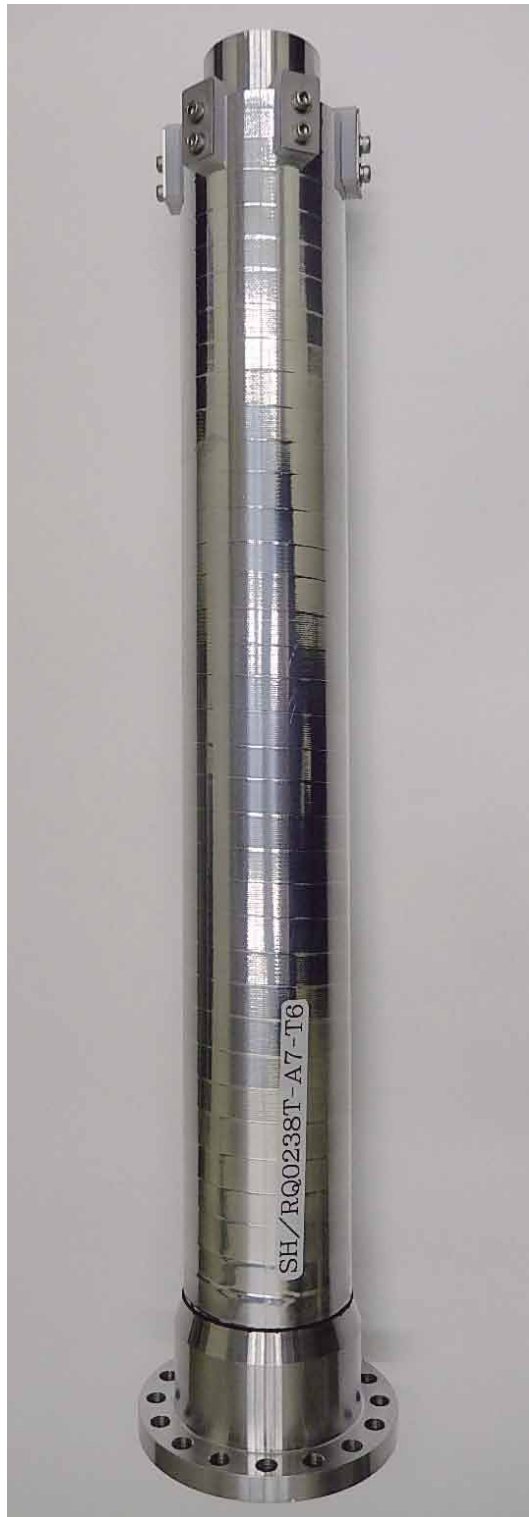
図 2-3 3重管トラス B(アルミ蒸着施工有)の写真
