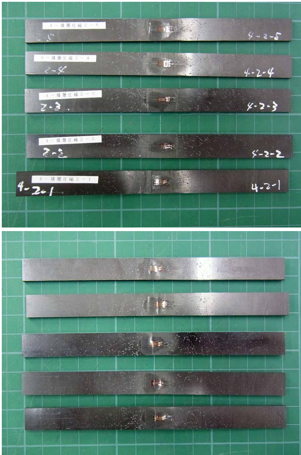
図 A-8 配向角 90°方向の圧縮試験が終了した後の試験片(上)表面(下)裏面
