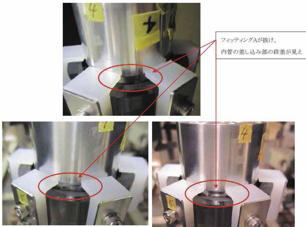
図 2-10 引張試験後の3重管トラスA 破損箇所
