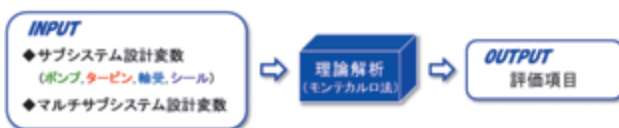
Fig. 13 内部循環流れの設計フロー
