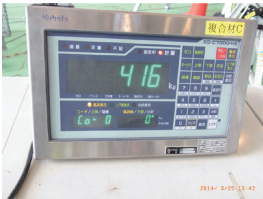
図 16 361a2-ult-1 試験での最大荷重時のはかりの読み
