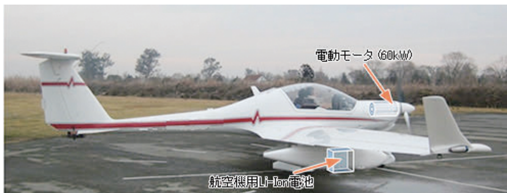
図 1 電動モータグライダーシステムの概念図
