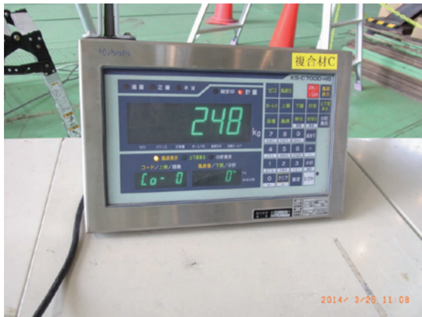
図 9 361a1-lim-1 試験での最大荷重時のはかりの読み
