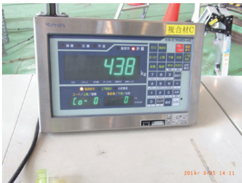
図 21 361a2-1.6-1 試験での最大荷重時のはかりの読み
