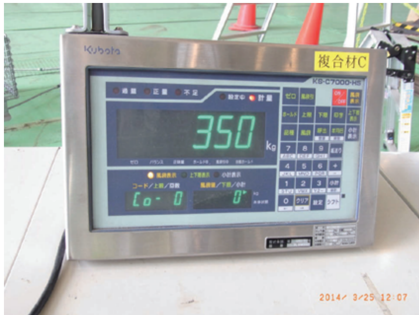
図 14 361a1-ult-2 試験での最大荷重時のはかりの読み
