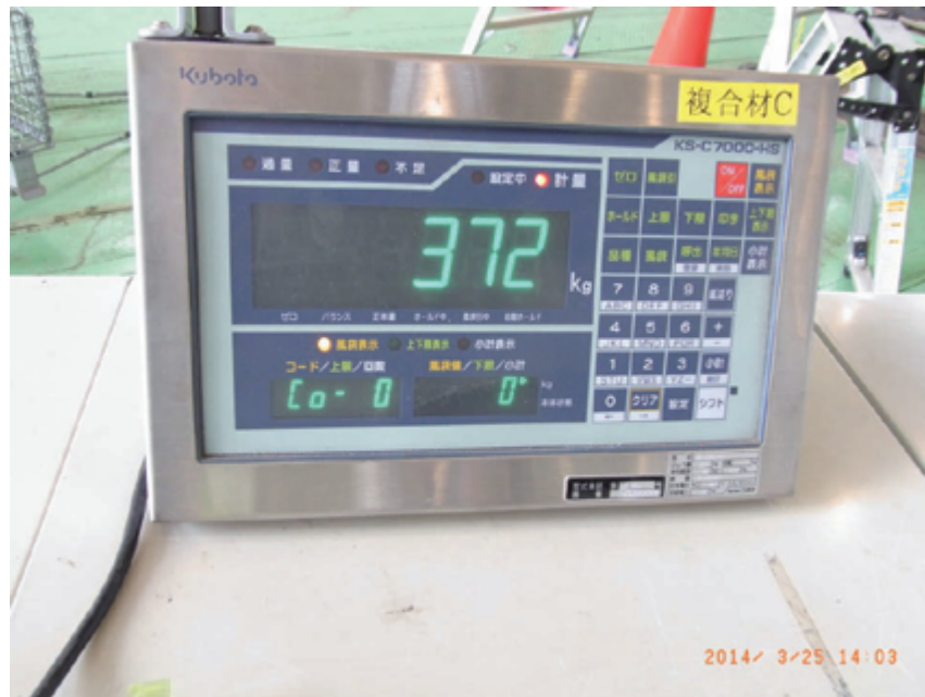
図 19 361a1-1.6-1 試験での最大荷重時のはかりの読み
