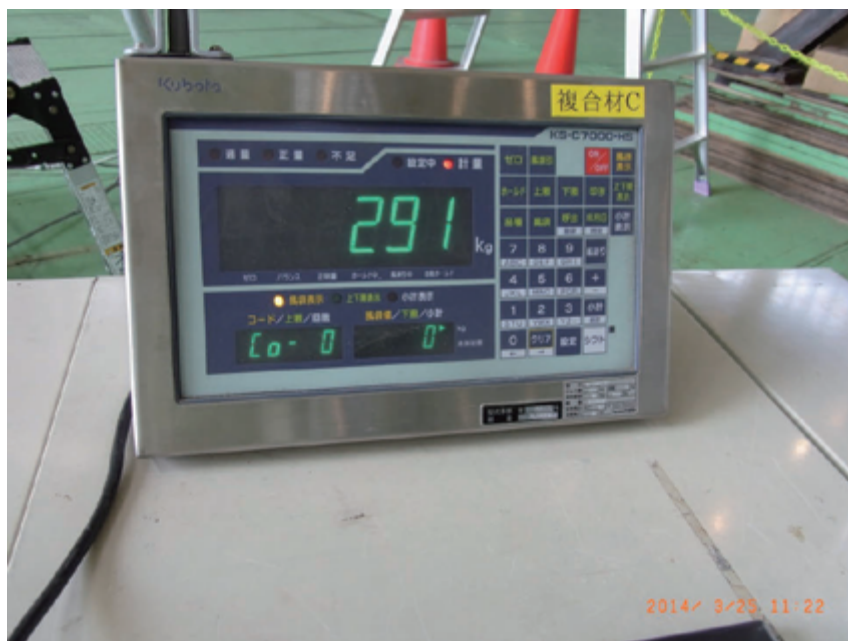
図 11 361a2-lim-1 試験での最大荷重時のはかりの読み
