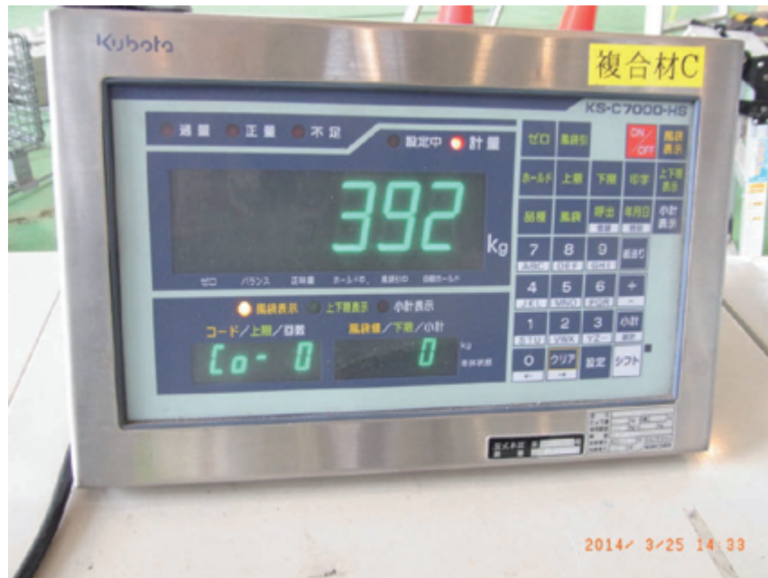
図 24 361a1-1.7-1 試験での最大荷重時ののはかりの読み
