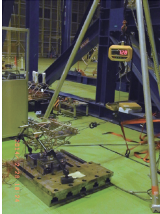
図 24 #1 供試体水平方向終局荷重(1)負荷時の写真
