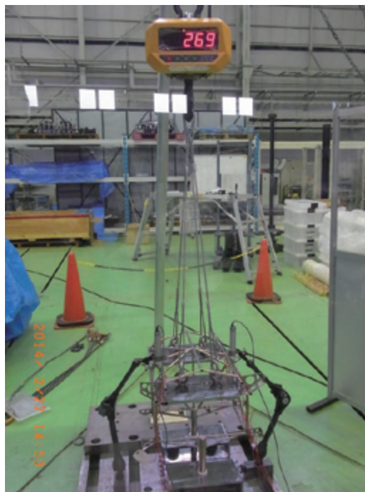
図 14 #1 供試体垂直方向制限荷重負荷時の写真
