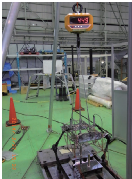
図 18 #1 供試体垂直方向 170%荷重負荷時の写真
