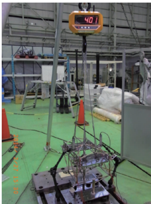
図 16 #1 供試体垂直方向終局荷重負荷時の写真
