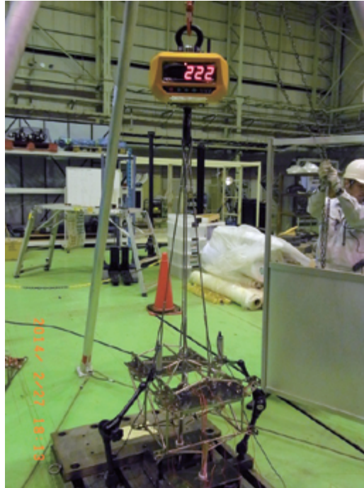
図 20 #3 供試体垂直方向実荷重負荷時の写真
