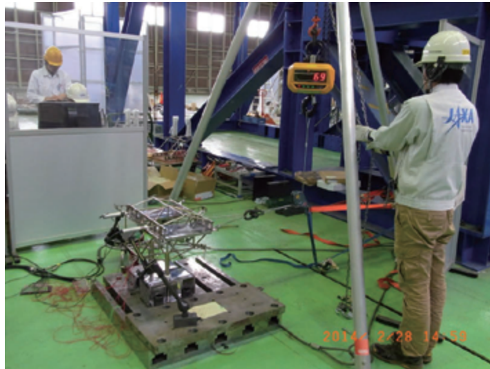
図 28 #2 供試体水平方向実荷重負荷時の写真
