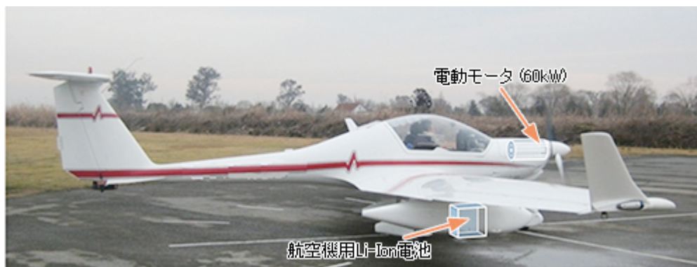
図1 電動化モータグライダシステムの概念図
