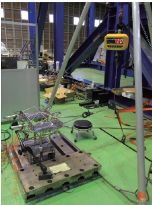
図 23 #1 供試体水平方向制限荷重(3)負荷時の写真
