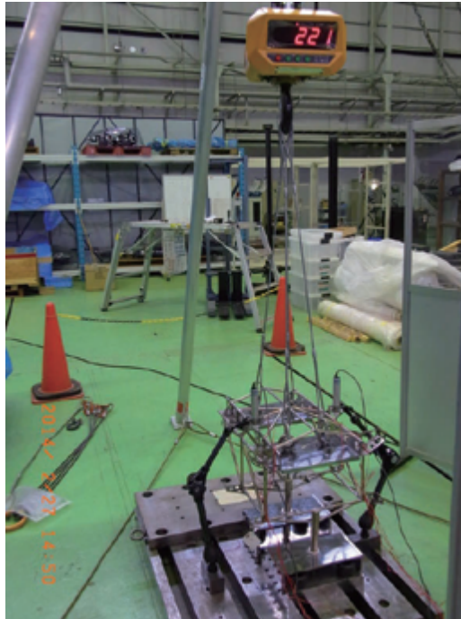
図 13 #1 供試体垂直方向実荷重負荷時の写真
