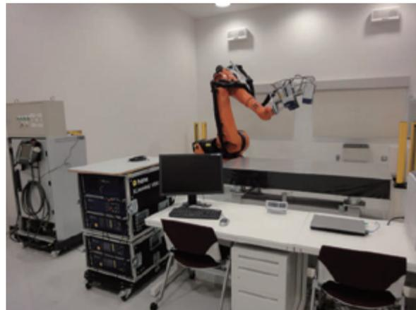
Fig.3.1 多軸振動非接触自動計測システム(MaVES)
