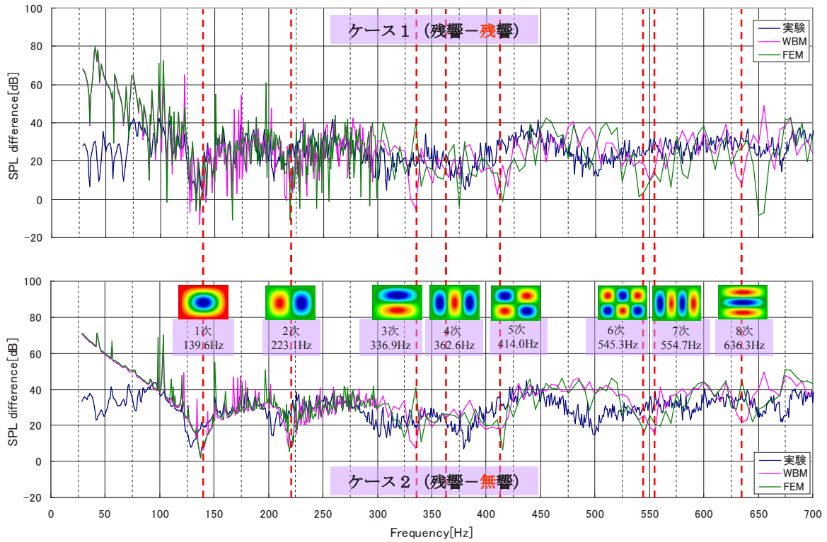
図 3.4 厚さ 10mm 弾性板の SPL\_difference 比較グラフ
