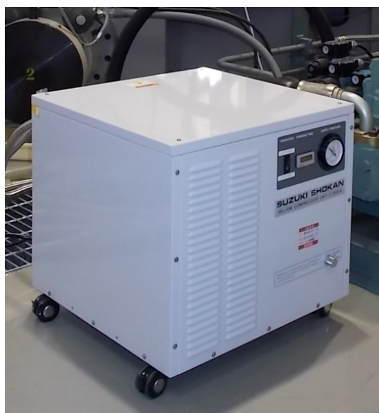
図 12 冷凍機用圧縮機
