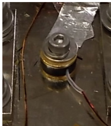
図19 冷却プレートに取り付けられた温度センサ
