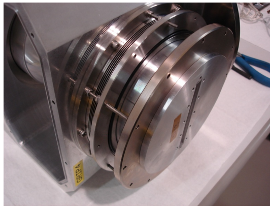
図 29 円筒部の環境槽上部への取り付け
