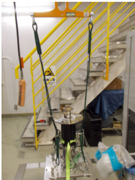
図 21 吊り具を用いた環境槽下部の吊り下げ
