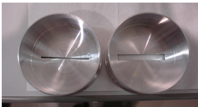
図 26 環境槽上部円筒部(左 : 2mm 板厚用, 右 : 6mm 板厚用)
