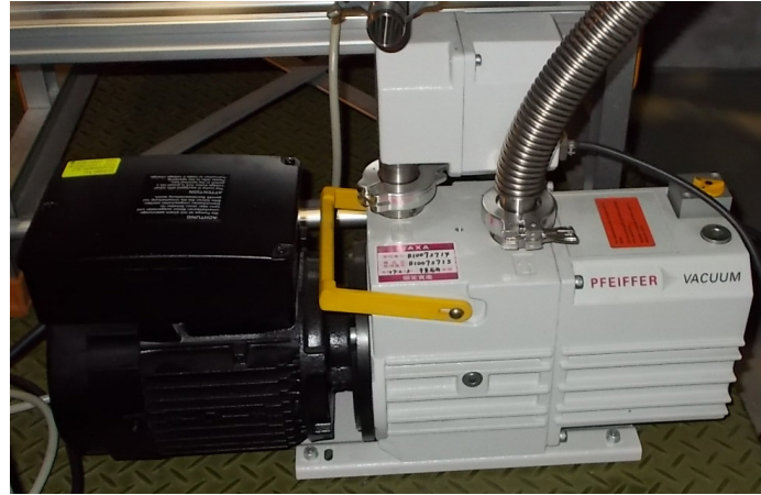
図 13 環境槽内排気用ロータリーポンプ
