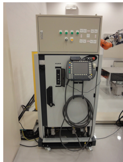
Fig.3.7 ロボット制御装置とティーチペンダント KCP
