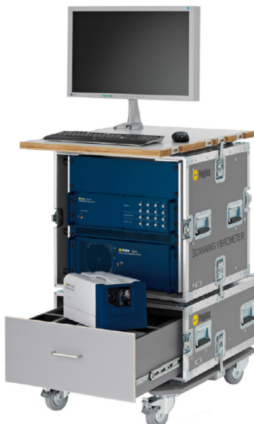
Fig.4.2 1D スキャニング振動計の構成 (ラック)
