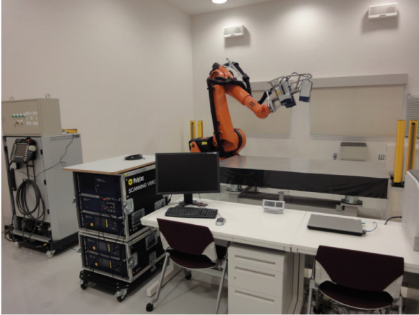
Fig.1.1 多軸振動非接触自動計測システム (MaVES)
