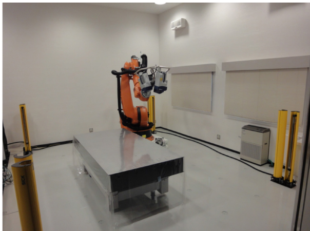
Fig.3.13 セーフティライトバリアの全景
