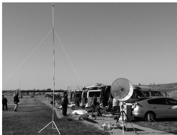
図23. 地上局アンテナ設置の様子(当初設置)
