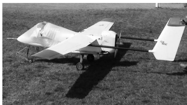
図24. キャノピー固定後の無人航空機の外観
