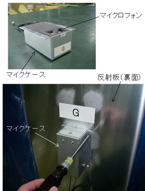
図 6-19: 地上マイクロフォンの取付け
