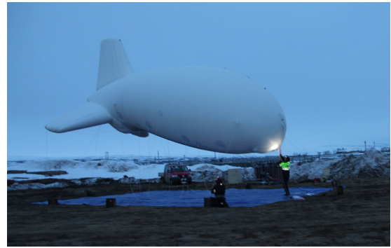
図 8-8: 係留気球ガス注入 (MP2(I))
