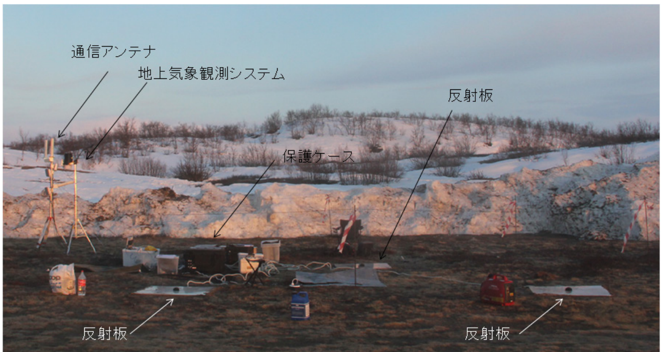
図 6-18: 地上計測システムの計測地点での展開 (MP2(I))
