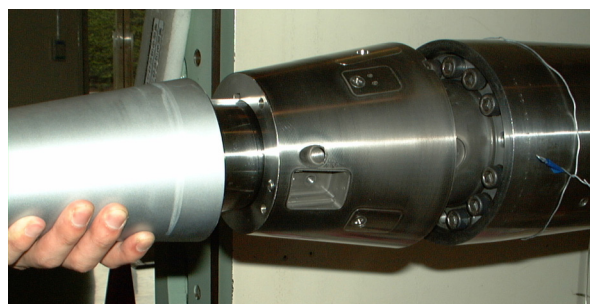
図 4 旧模型支持装置パワーロックとテーパスティング
