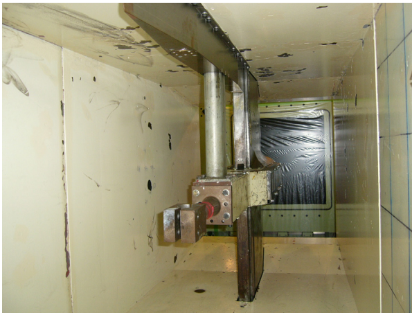
図 7 下流側からみた旧模型支持装置と電線管
