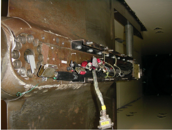
図 6 旧模型支持装置の追加センサスペース
