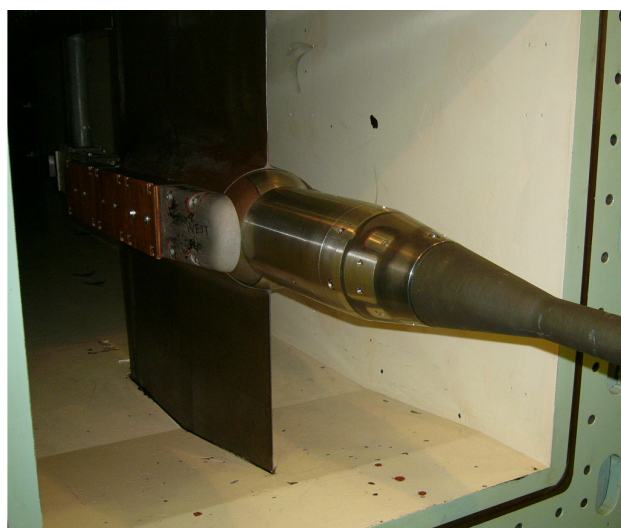
図 19 ポッド側面厚さ追加試験
