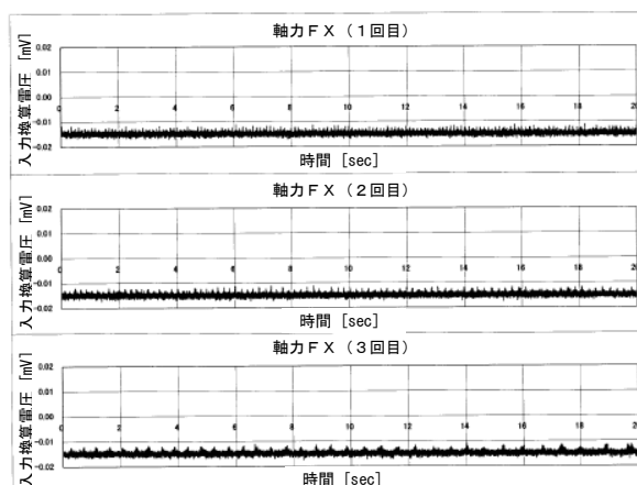
図 20 サーボ off 時の信号波形
