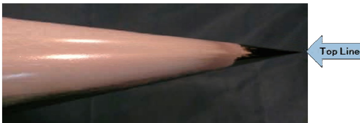
図 5 オイルフローを用いた表面流れの可視化(円錐模型; \alpha=2\text{deg} )
