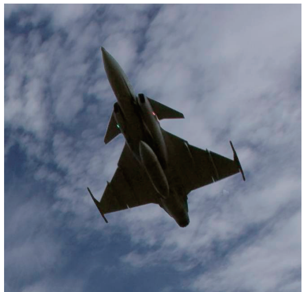
増槽タンク搭載機体形状
