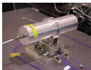
(b) 冷凍機用コンプレッサ
