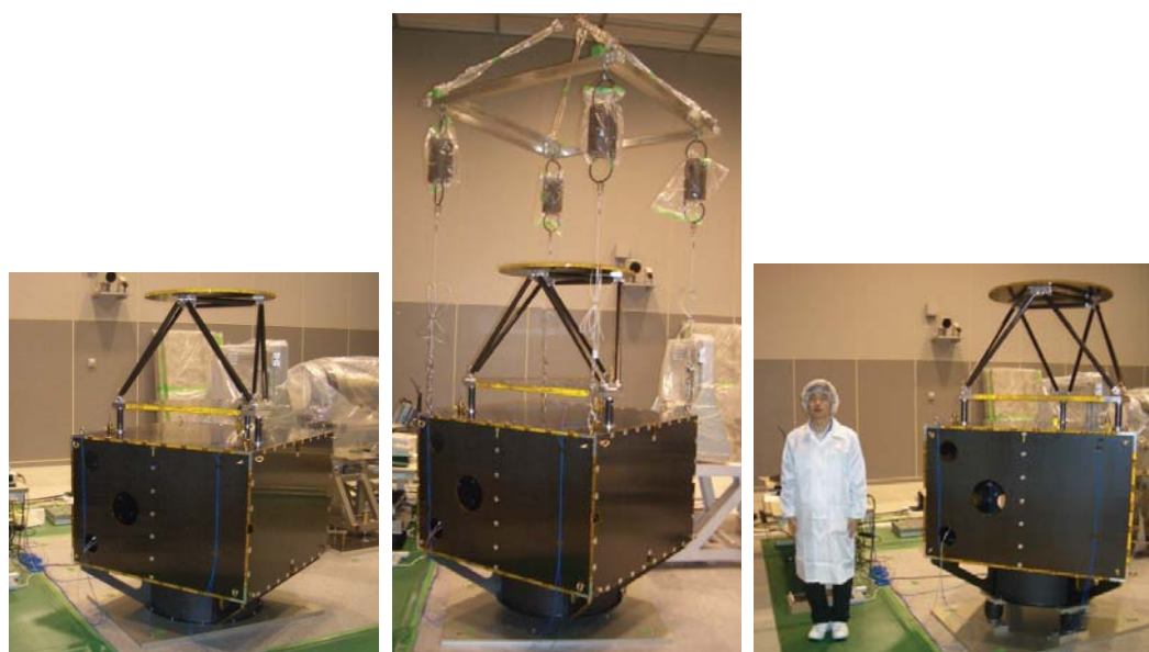
(a) 定盤直置き (b) 宙吊りバネ支持 (c) 空気バネ支持
