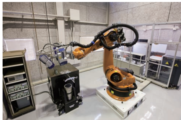
Fig.1.2 多軸振動非接触自動計測システム (MaVES)
