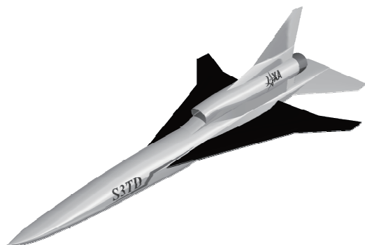
図 1.1 静粛超音速研究機の概要
