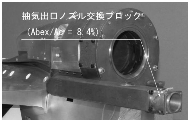
(b) 交換式抽気出口ノズル ( A_{bex}/A_c = 8.4\% )
