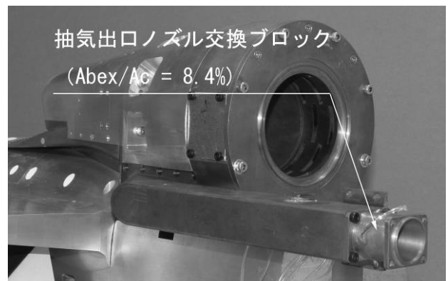
(b) 交換式抽気出口ノズル ( A_{bex}/A_c = 8.4\% )
