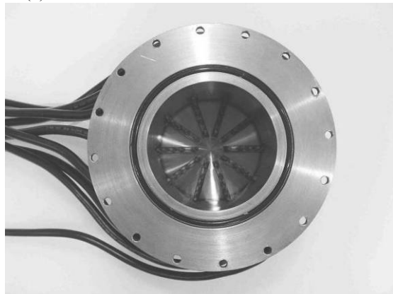
(b) 非定常総圧レークの概観 図 3.8 非定常総圧レークの概要
