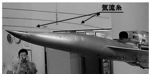
図 3.12 気流糸による可視化
