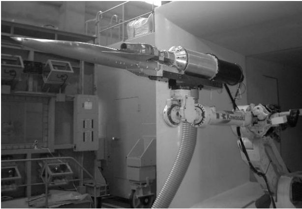
図 3.2 低速風洞搭載状態
