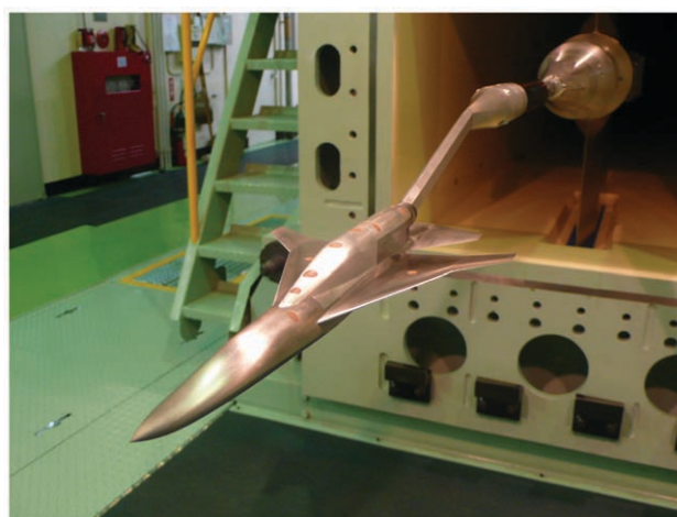
(b) 模型写真 (2.5% 模型)
