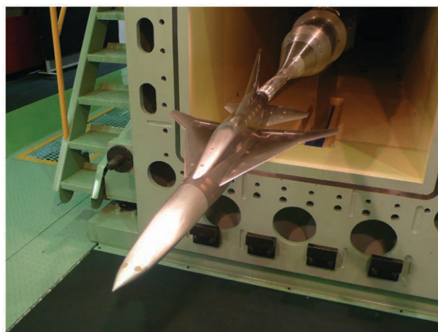
(a) 基本全機超音速風洞試験 (5%模型)
