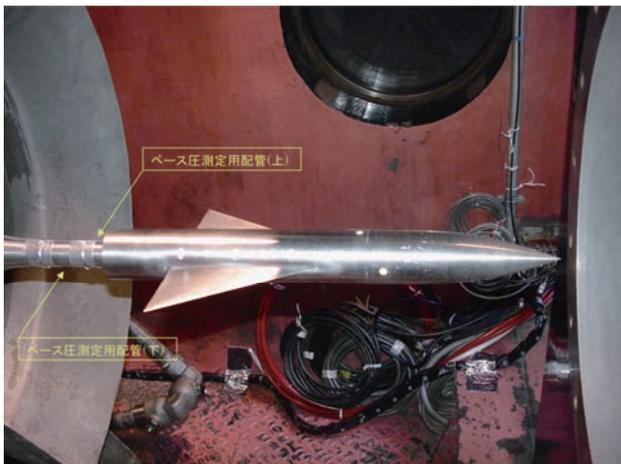
図 2.2 スティングに取り付けられた AGARD-B 標準模型
