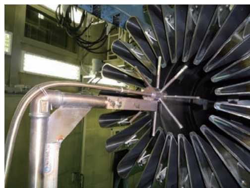
図 28 エンジンノズル後方にセットしたサンプリングプローブ
