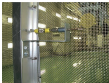
図21 エンジン入口全温計測用RTD
