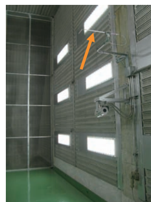
図22 エンジン入口全圧計測用ピトー管 (矢印)
