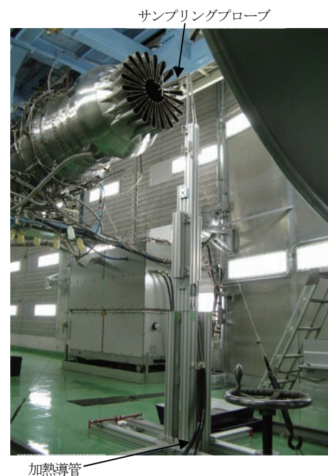
図 24 排気ガス分析、排煙濃度計測 実施例
