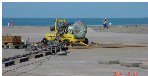
図3-2 第1回屋外エンジン運転試験の様子
