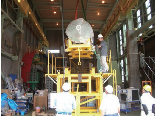
図4.2-8 高所架台へのエンジン搭載作業
