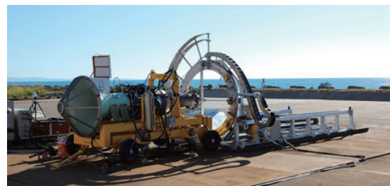
図4.2-29 排気トラバース試験形態
