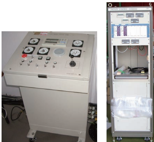
図4.1-7 エンジン運転操作盤(左)と計測パネル(右)
