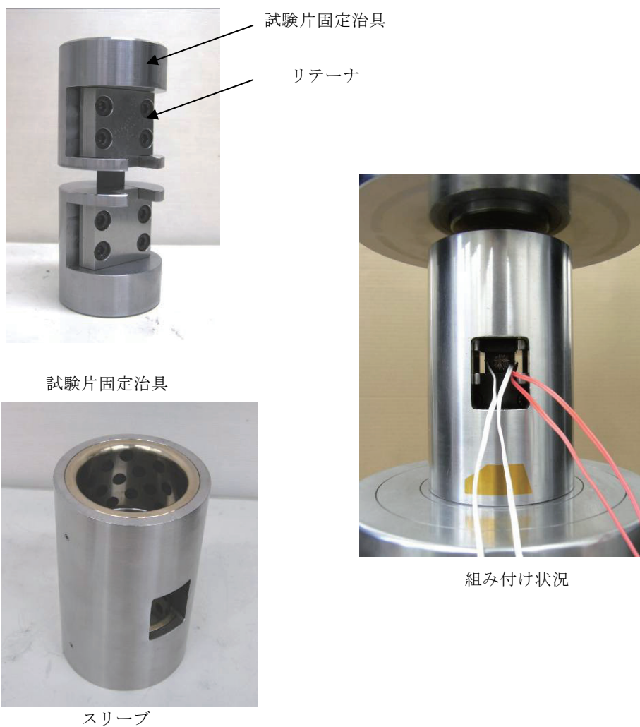
図4 NAL-NHC-II法 (NAL-II法) の治具写真
