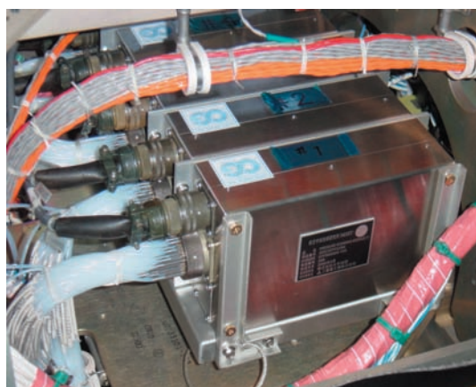
図8 圧力走査器(搭載状況)
