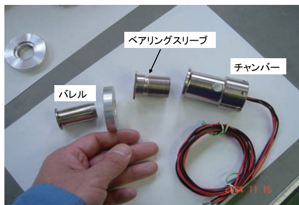
図 3.3-4 メインコンテナ分離機構写真
