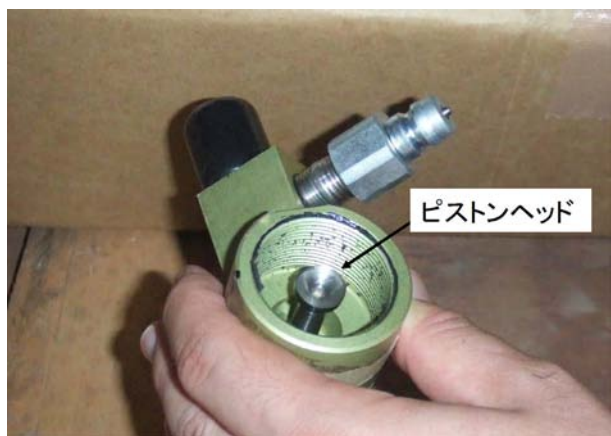
図 3.7-5 実際のピストンヘッドの写真
