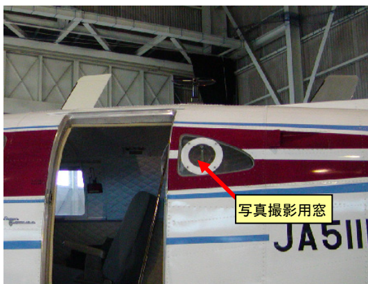
写真12 エアロゾル測定窓（写真用窓）
