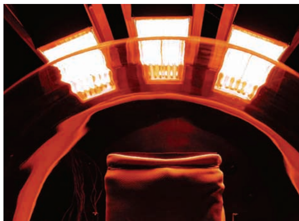
写真3 赤外線ランプ照射加熱状況
