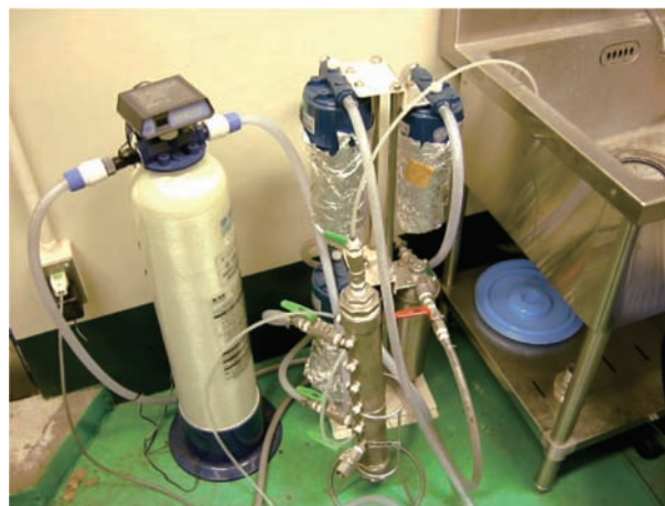
図23 精製水製造装置
