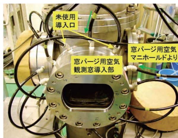
図13 窓パージ用空気系統：観測窓導入部
