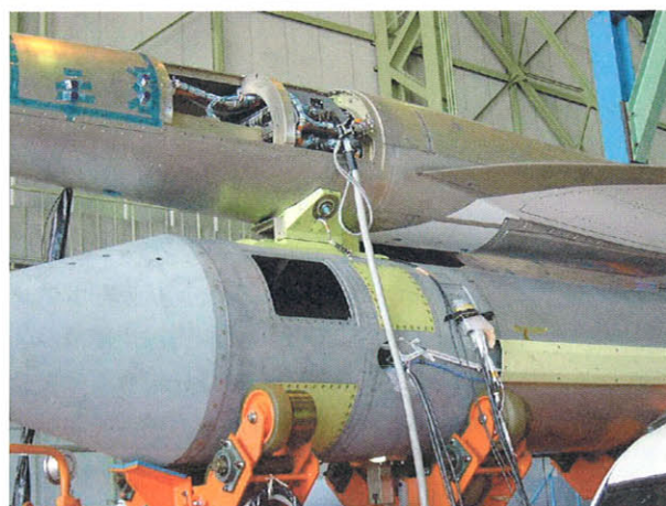
図 3-7 誘導計測部の実装写真
