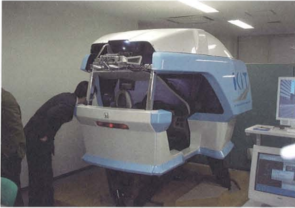
Fig. 4-6 路面評価型ドライビングシミュレータ (北見工業大学)
