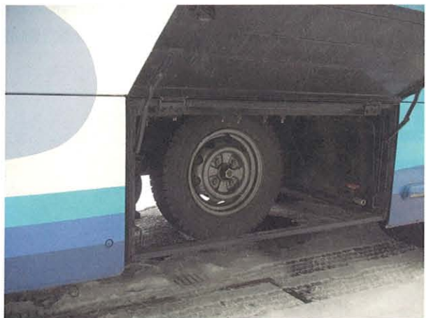
Fig.4-8 バス型摩擦係数計測試験車 (開発土木研究所)
