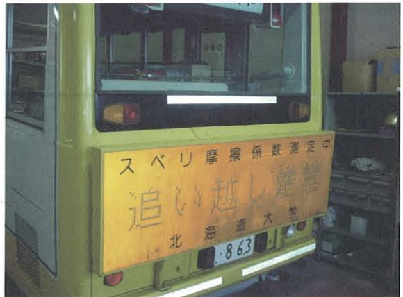
Fig. 4-5 バス型摩擦係数計測試験車 (北海道大学)
