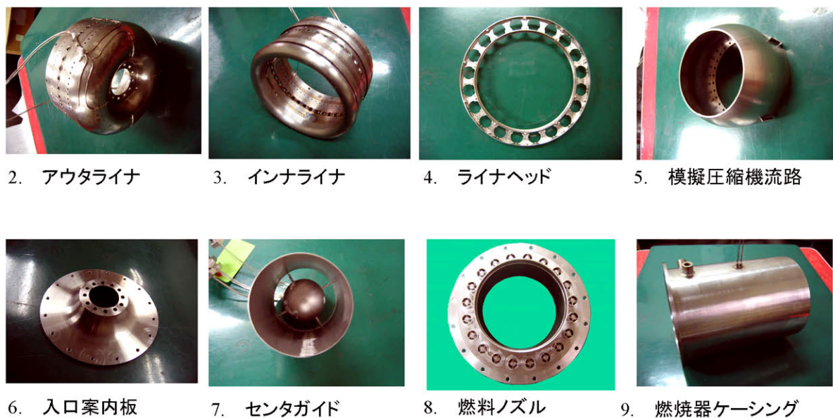
図9 燃焼器主要構成部品（番号は、図8に対応）
