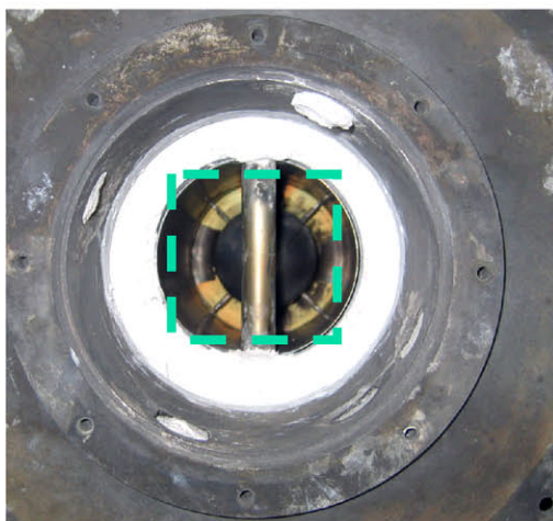
(a)燃焼器模型出口（供試体が断熱材で覆われている）(b) 燃焼試験時写真（(a)の破線枠内；センターガイドが赤熱している）
