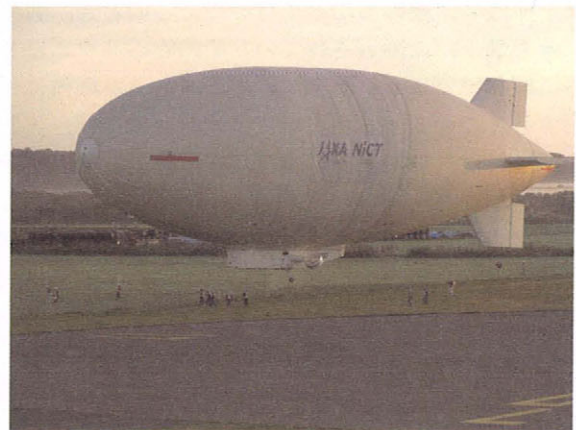
図 4.1-2 離陸直後の定点滞空試験機
