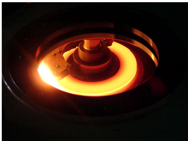
図 9 SiC/SiC ディスク加熱状況 (930℃,20,000rpm)
