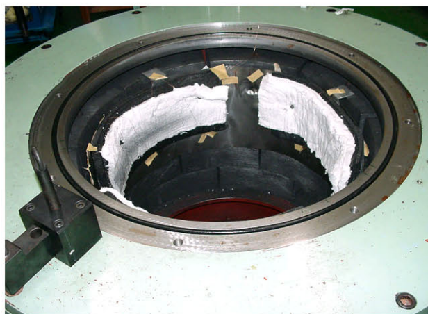
図 13 コンテナメント（破片回収）
