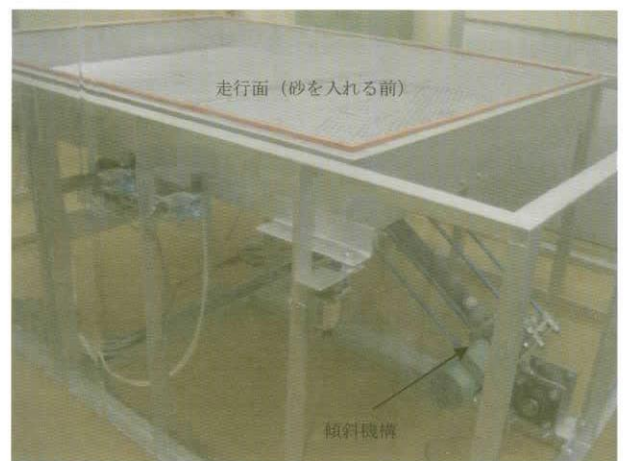
図2 斜面走行試験装置外観（完成時、上面）
