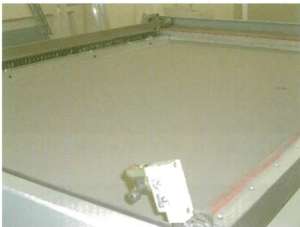
図9 均し完了時の走行面
