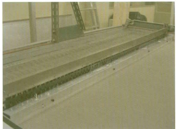
図5 均し機全景(均し動作途中)
