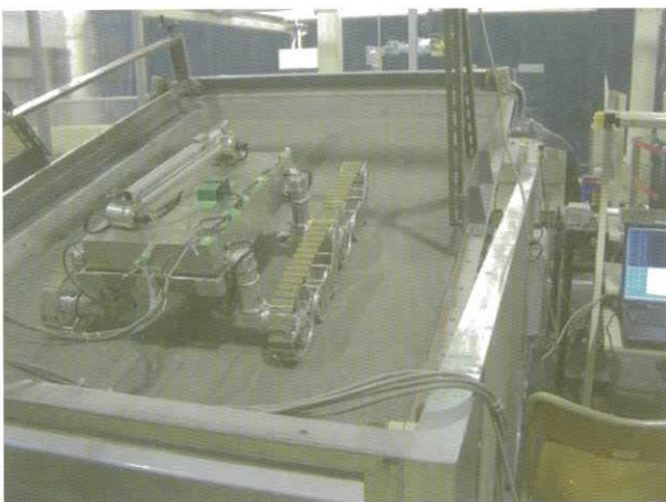
図11 斜面走行実験の様子（クローラ車の場合）
