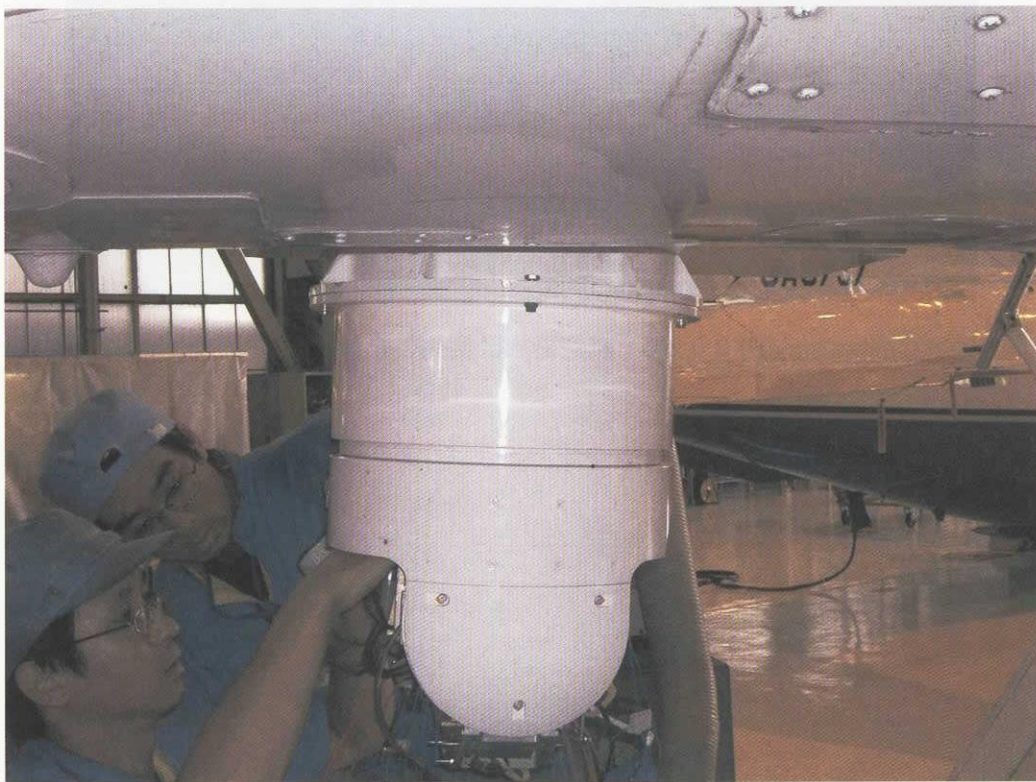
図 3.5.2-5 加速度センサ取り付け作業風景(その 2)
