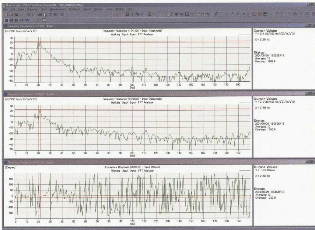
図 D-7 試験 ID Afr-3 インパクト点カメラポッド下部(-x 方向) バネ付き 1 2 A1_x 及び A3_x の A2_x に対する伝達倍率、A1_x と A3_x の位相差
