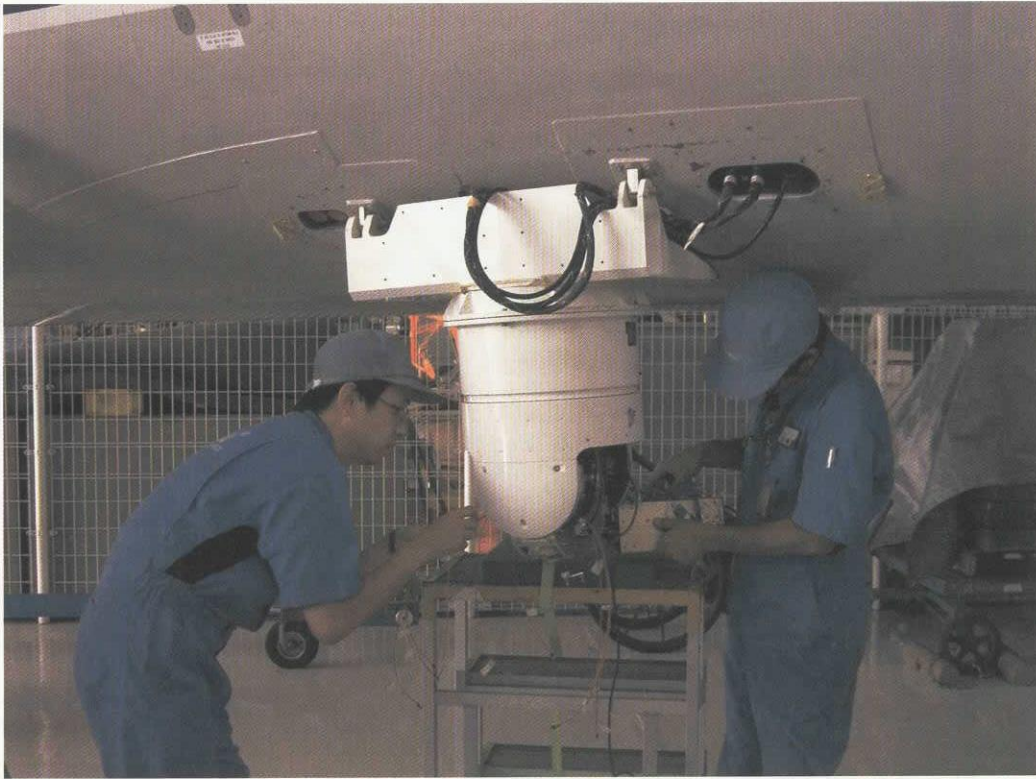
図 3.5.2-4 加速度センサ取り付け作業風景(その 1)
