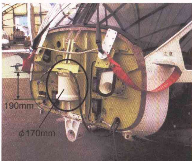
図2.2 超音波速度計：接続箱 (カイジョーソニック OA-60A)
