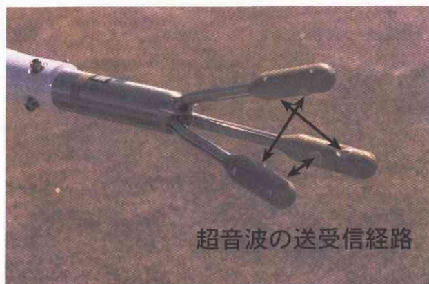
図2.1 超音波速度計：測定部 (カイジョーソニック TR-99HC)
