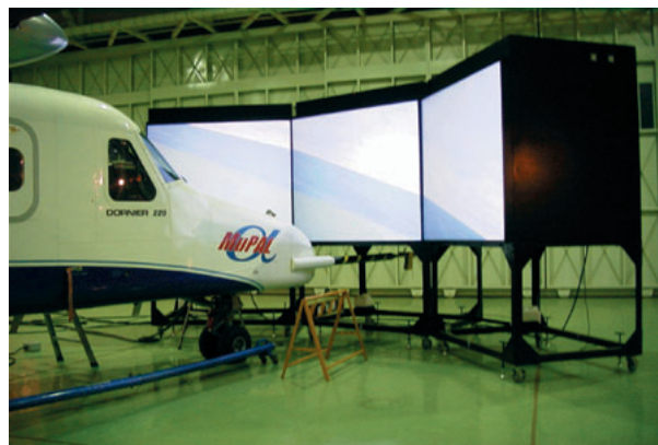
図5-2 模擬視界システム部(背面投影型ディスプレイ)
