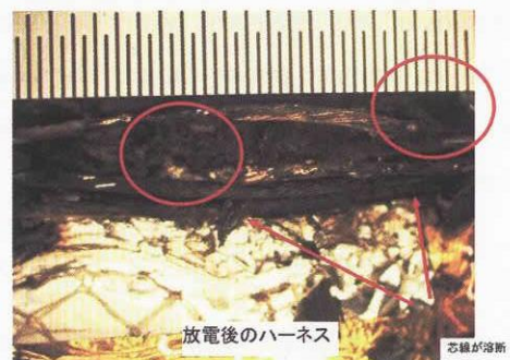
図1 持続放電後の電力ハーネス
