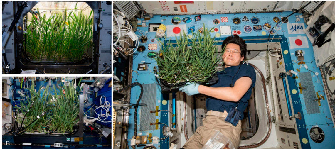
図 2.8 NASA 植物栽培装置 Advanced Plant Habitat (APH)
