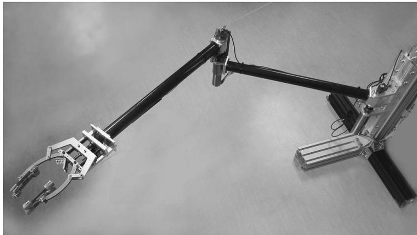
図 デブリ捕獲用軽量ロボットアームの試作機
