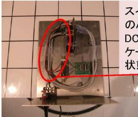
スイッチング電源へのAC入力(1次側)とDC出力(2次側)のケーブルが密着した状態になっている。
