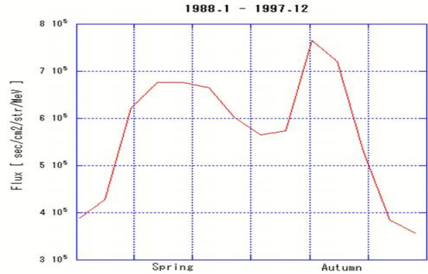
図 3: ETS-V が観測した MeV 電子フラックスの季節変化。3月と8月に MeV 電子のピークが確認される。
