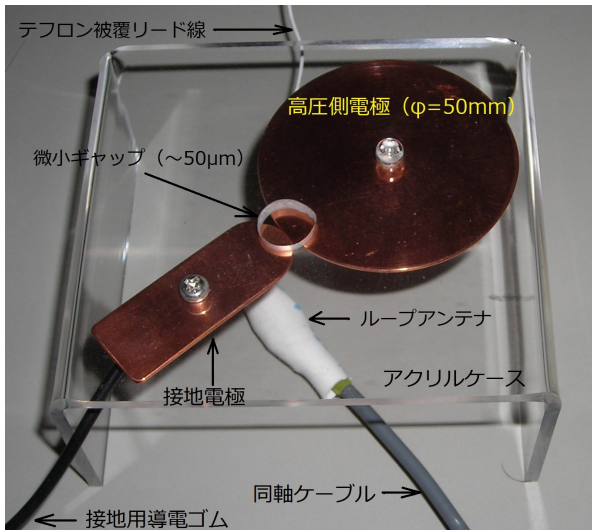
図 6：微小ギャップとループアンテナ 高圧側電極（銅板）と接地電極（銅板）間のギャップ幅は、シムゲージを使って調整するが、今回は 50 μm とした。この間隙では大気圧中で、概略 650V 前後で放電する。ループアンテナは接地電極の下、約 30mm に配置している。
