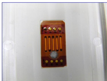
最高到達温度モニタ（ExHAM側）の様子
