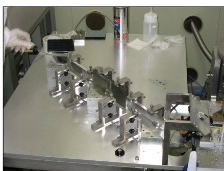
テラヘルツ波反射率測定 (640GHz) @JAXA TKSC
