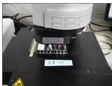
金属顕微鏡による鏡面撮影の様子
