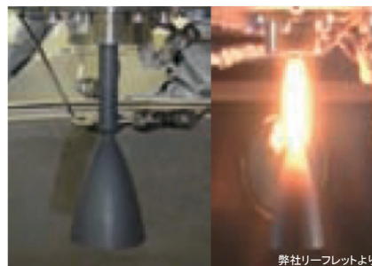
10Nセラミックスラスタ燃焼試験状況
