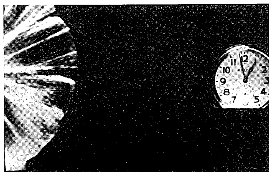
c) 放球後 180 分，高度 24.1 km 容積 1/3 収縮 フィルタ：黄 (SC-54) 露光時間：0.8 ms
